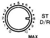
この使い方により、走行時のセッティングの幅が大きくなり、アンダーステアやオーバーステアを感じた時、ピットに入らないで送信機で微調整が可能になります。
